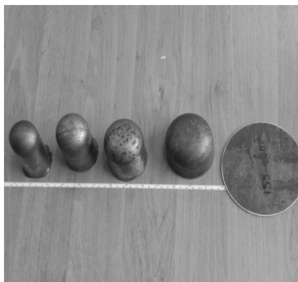
شکل (۱) مراحل تولید قطعه‌ی صنعتی به کمک فرآیند کشش عمیق
