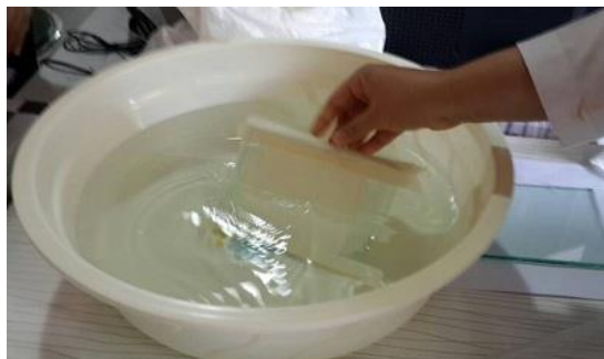
شکل ۳- مرحله شکل گرفتن غشاء در حمام انعقاد و ظروف نگهداری غشاء حاوی آب مقطر
