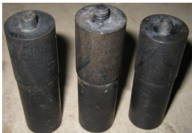
شکل ۱- ابزارهای مورد استفاده: از سمت چپ، ساده، رزوه دار و مخروطی
