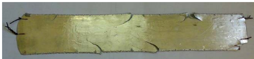
شکل ۲- ورق کامپوزیتی ARB شده تا ۸ سیکل که عیوب و پارگی کنار ورق مشهود است.
