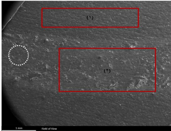
شکل ۹- تصویر میکروسکوپ الکترونی از سطح سایش یافته پوشش PEO کامپوزیتی
