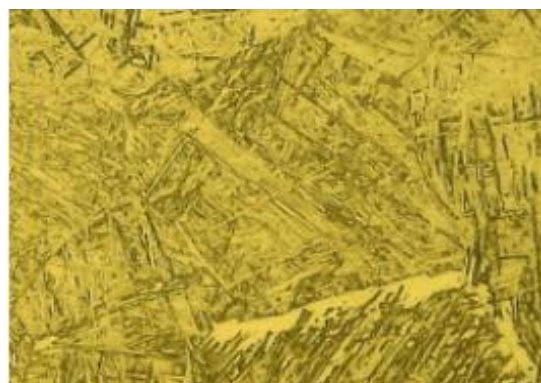
شکل ۲- ریزساختار فلز پایه شامل ساختار دوفازی \alpha به همراه \beta در نمونه جوشکاری شده با شدت جریان ۷۰ آمپر.
