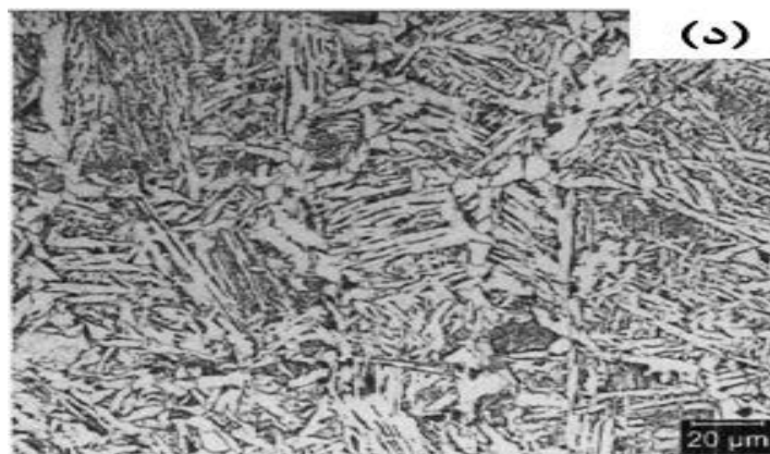
شکل ۶- تصویر میکروسکوپ نوری ریزساختار منطقه ابتدای HAZ (نزدیک فلز جوش) برای نمونه‌های مختلف: (الف) A2، (ب) A3، (ج) A4 و (د) A5
