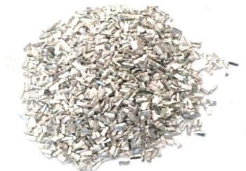
شکل ۱- براده‌های ماشین کاری شده‌ی آلیاژ منیزیم AZ91D
