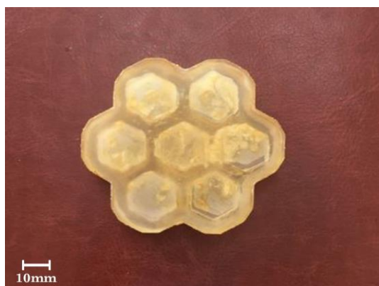
شکل ۳- تصویر نمونه پانل ساندویچی تکفاز
