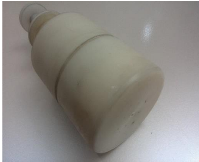
شکل ۴ - اسپینرت استفاده شده در مالتی-جت الکترورسی
