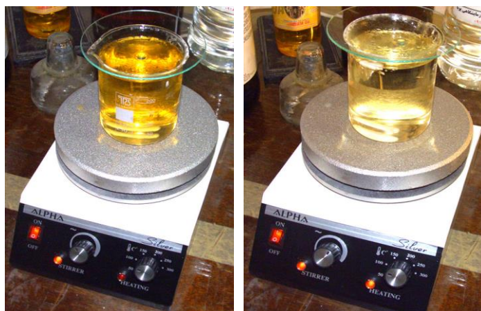
شکل ۲- محلول سازی با استفاده از همزن مغناطیسی، ۳۰ دقیقه و ۹۰ دقیقه پس از هم زدن در دمای ۸۵ درجه سانتی‌گراد
