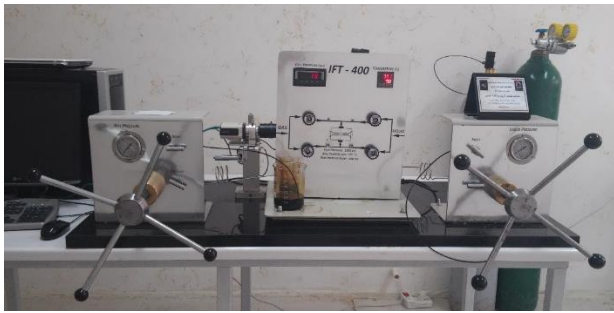
شکل ۱: دستگاه اندازه گیری کشش بین سطحی سیالات به روش قطره آویزان
