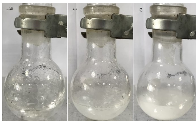
شکل ۱: واکنش سنتز نانوذرات اکسید روی در دمای اتاق، قبل از افزودن هیدروکسید سدیم (الف)، بعد از افزودن هیدروکسید سدیم (ب) و بعد از ۲۴ ساعت واکنش (ج)، ایجاد رنگ شیری نشانه اولیه در خصوص شکل گیری ذرات اکسید روی می باشد.
