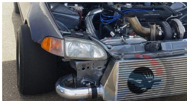
شکل ۷. اینترکولر و افتر کولر در سیستم توربوشارژر [13]
