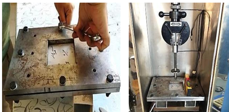
شکل ۳) نحوه قرارگیری نمونه در فیکسچر و دستگاه آزمایش نفوذ شبه استاتیکی
