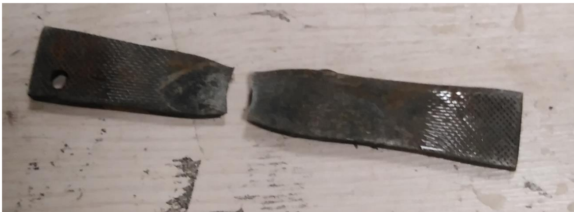
شکل ۱۳- نمونه آزمایشگاهی بعد از آزمون کشش
