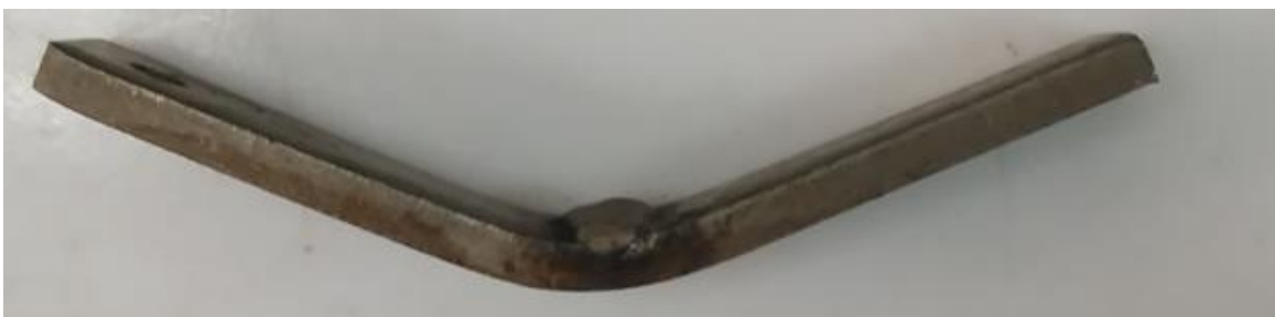
شکل ۱۱- نمونه آزمایشگاهی بعد از آزمون خمش
