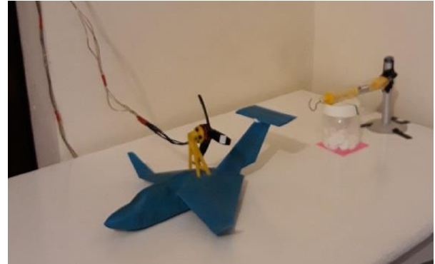
شکل ۴- نحوه اتصال جسم پرنده با ملخ به نیروسنج
