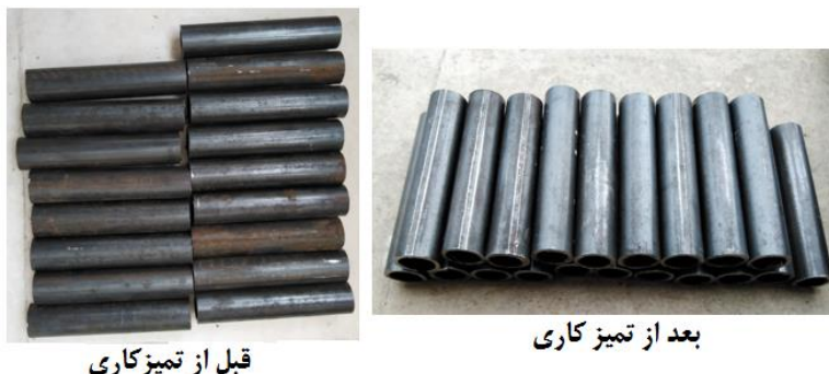
شکل ۲- نمونه های آماده شده برای جوشکاری قبل و بعد از تمیز کاری
