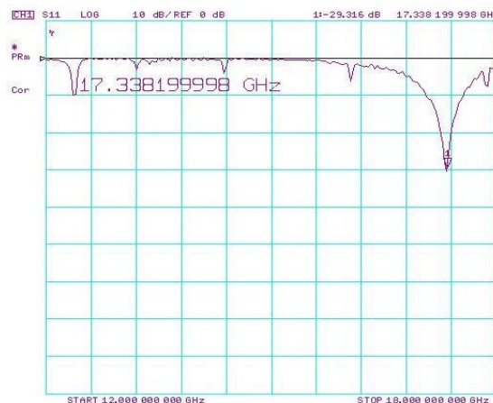
شکل (۹): اندازه گیری پارامتر S_{11} برای قطعه دی الکتریک مجهول Fig. (9): The measurement of S_{11} parameter for an unknown dielectric
