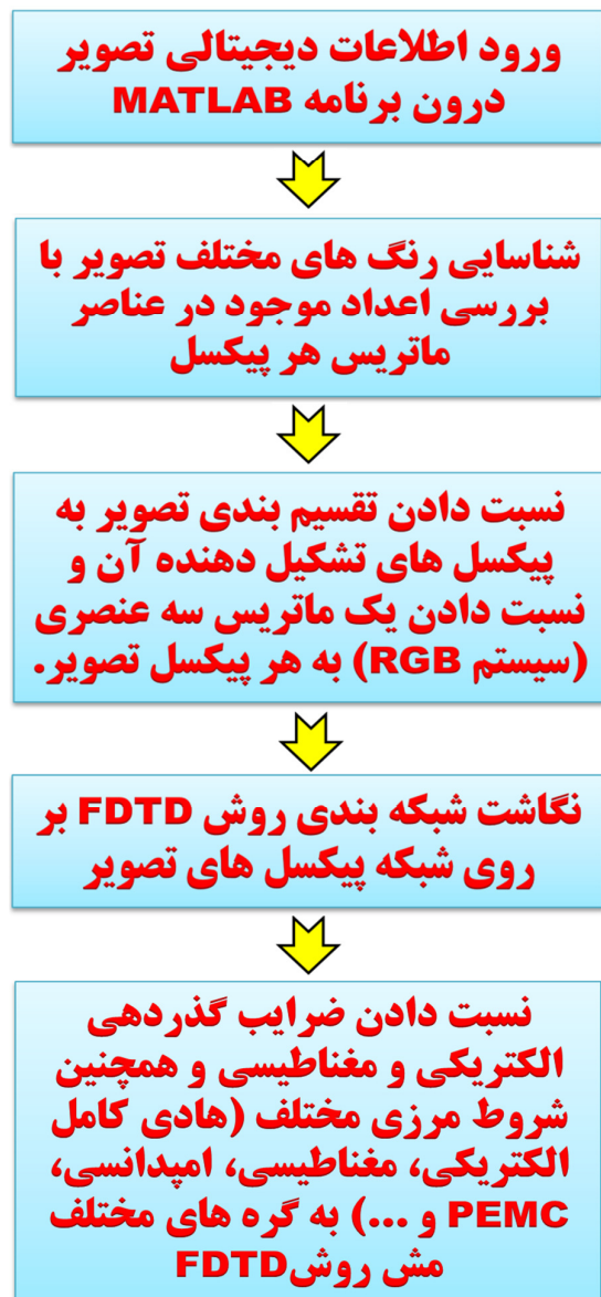
شکل (۹): فلوجارت الگوریتم مورد استفاده در پردازش تصاویر Fig. (9): The flowchart of the algorithm used in image processing
