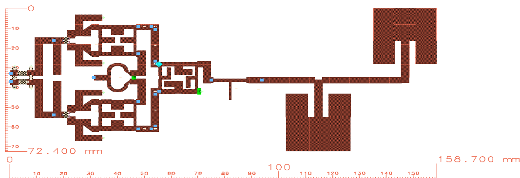
شکل (۱۸): طرح بندی AIA با IRM پیشنهادی Fig. (18): Layout of the proposed AIA with IRM
