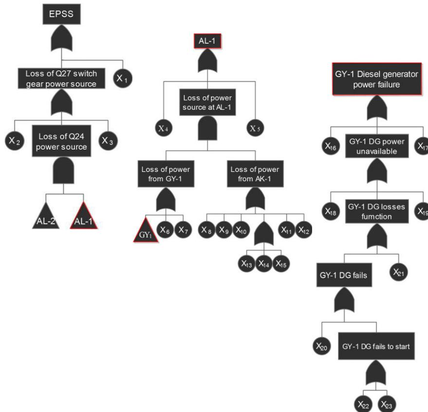
Fig. 5. EPSS fault tree
