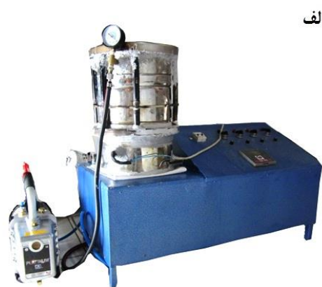
شکل ۱- سامانه سرخ‌کن تحت خلأ: الف) سرخ‌کن ساخته شده، ب) نمای شماتیک سرخ‌کن.
