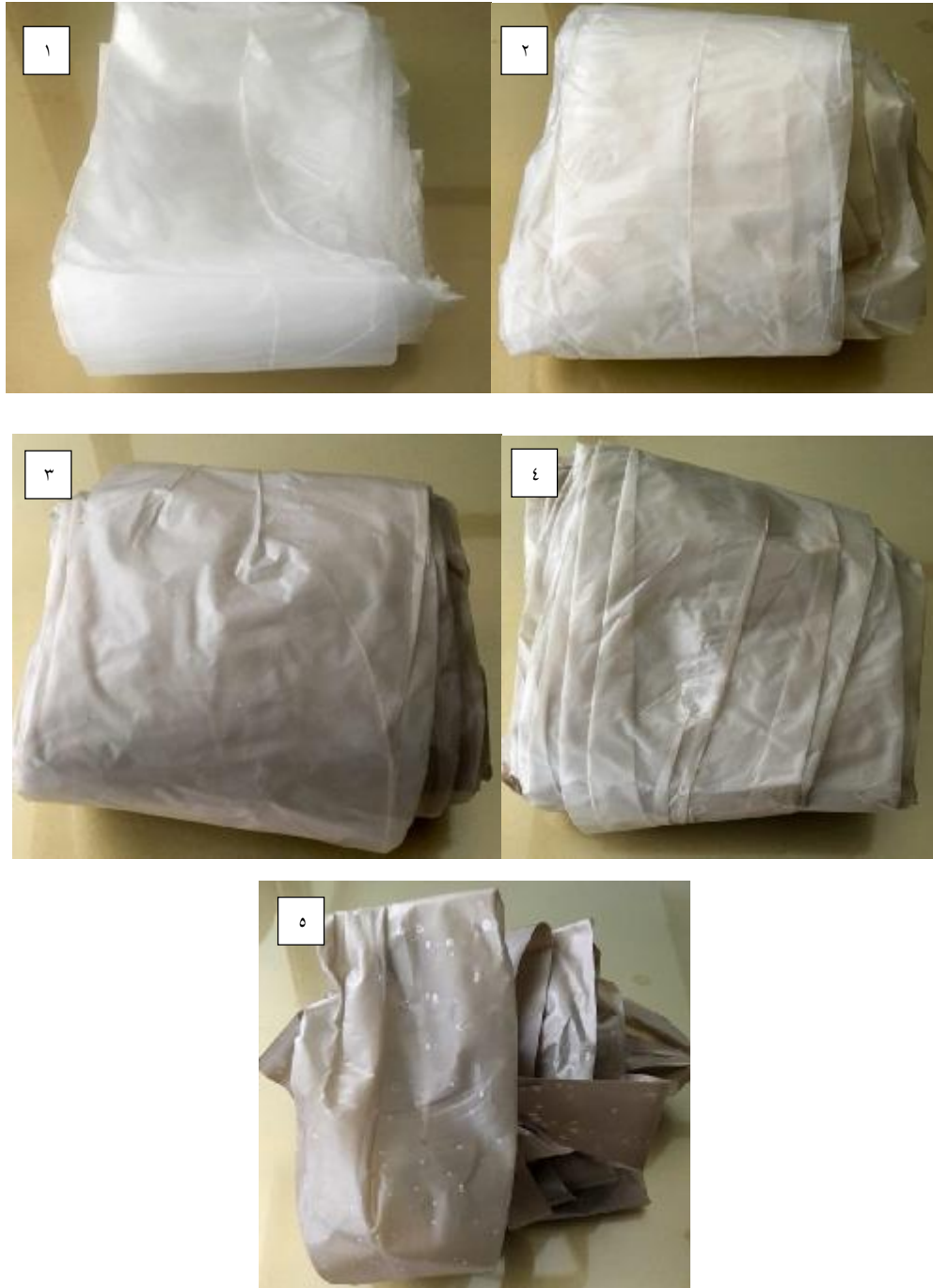
شکل ۱- نمونه های پوشش پلیمری حاوی صفر، ۰/۵، ۱، ۲ و ۳ درصد نانوذرات نقره به ترتیب در شکل های (۱) تا (۵)
