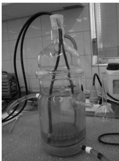
شکل ۲- راکتور دو جداره به همراه الکترودها در حلال
