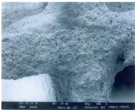
شکل ۲- تصویر تقاطع دو دیواره مونولیت لانه زنبوری با بزرگنمایی ۴۰۰ برابر
