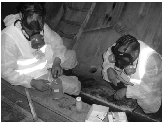
شکل ۱۰- نمونه برداری از آب داخل تونل
