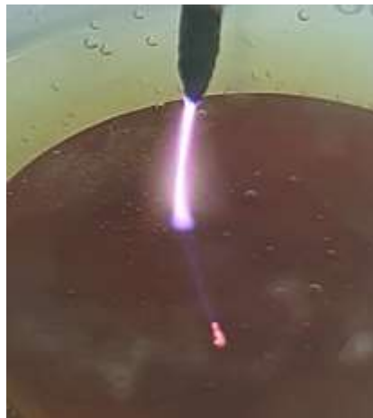
شکل ۴- پلاسمای شکل گرفته در سطح مشترک گاز_مایع
