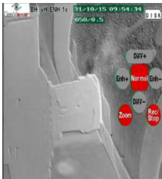
شکل ۱- نمونه ای از تجهیزات دارای نشت شناسایی شده توسط LDAR
