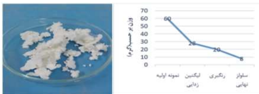
شکل ۲- سلولز استحصالی (راست)، میزان کاهش وزنی نمونه در مراحل مختلف تیماردهی (چپ)
