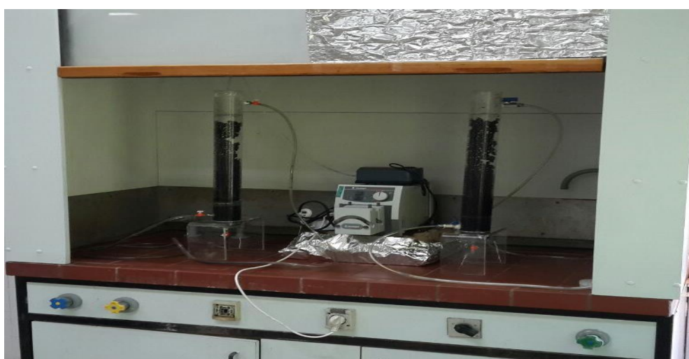
شکل ۱- رآکتورهای نیتریفیکاسیون (سمت چپ) و دنیتریفیکاسیون (سمت راست) در زیر هود بیولوژیکی
