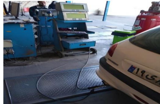
شکل (۲): نحوه قرارگیری پروب دستگاه آنالیزور دود (پنج‌گاز) در اگزوز خودرو در حالت درجا
