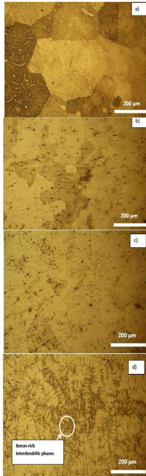
Fig. 1. LOM images of as-cast alloys a) FeAl b) FeAl-0.1B, c) FeAl-0.5B d) FeAl-1B.
