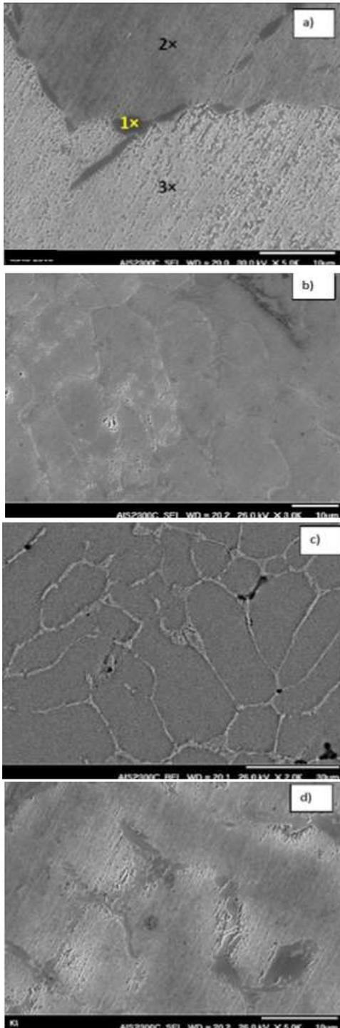
Fig. 2. SEM images of as-cast alloys a) FeAl b) FeAl-0.1B, c) FeAl-0.5B d) FeAl-1B.
