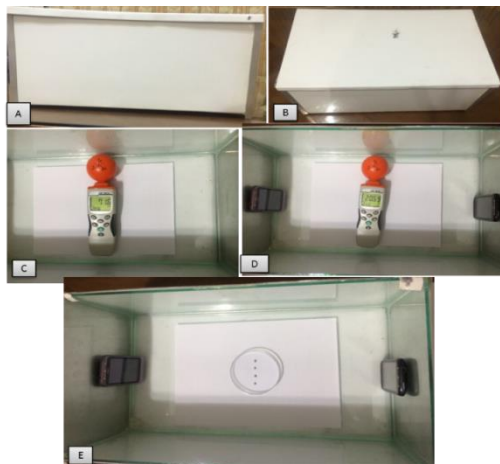
شکل ۱- A و B: اتاقک شارما، C و D: نحوه قرار دادن تلفن‌های همراه و دستگاه اندازه‌گیری امواج الکترومغناطیس درون اتاقک شارما، E: نحوه قرارگیری تلفن‌های همراه و بذرها در داخل اتاقک شارما.
