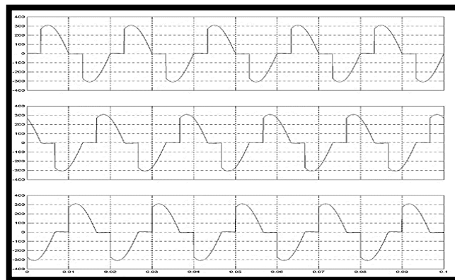
شکل (۸): شکل موج کل ولتاژ خروجی مبدل فازهای R,S,T
