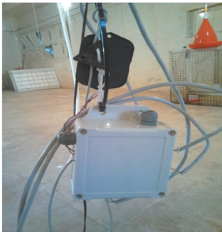
شکل ۲۰. محل قرارگیری حسگر دی اکسید کربن و آمونیاک
