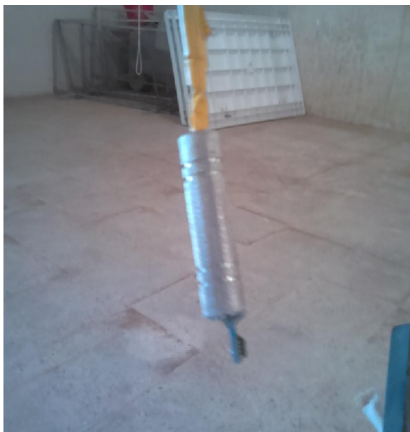
شکل ۱۸. محل جایگذاری حسگر رطوبت در ارتفاع ۶۰ سانتیمتری
