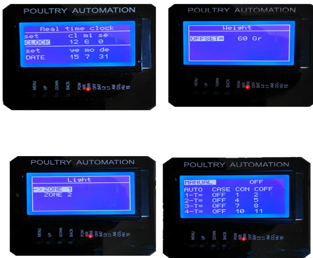
شکل ۱۵. منو دستگاه (روشنایی و وزن و تاریخ)
