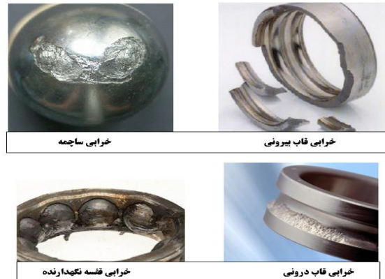
شکل ۱ - عیوب اعمالی بر بال یاتاقان
