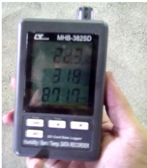
شکل ۳- الف- سنجهش دمای آب موتور با گرم‌نگار لیزری ب- سنجهش دمای هوای آزمایشگاه توسط گرم‌نگار حرارتی
