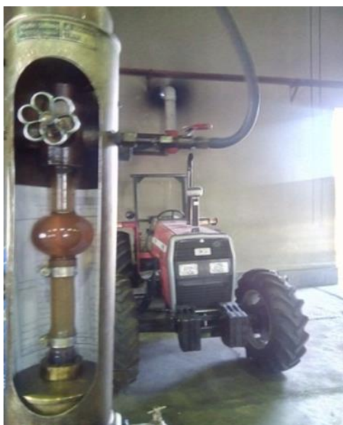
شکل ۲- الف- سمت راست جایگاه دستگاه دینامومتر ب- سمت چپ جایگاه تراکتور در کنار سوخت سنج
