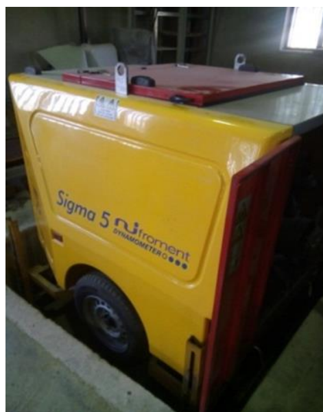
شکل ۲- الف- سمت راست جایگاه دستگاه دینامومتر ب- سمت چپ جایگاه تراکتور در کنار سوخت سنج
