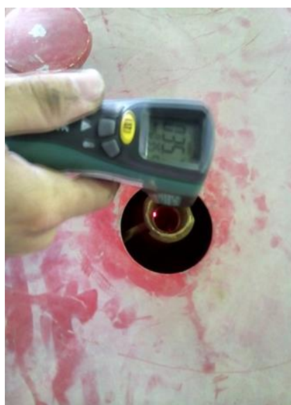
شکل ۳- الف- سنجهش دمای آب موتور با گرم‌نگار لیزری ب- سنجهش دمای هوای آزمایشگاه توسط گرم‌نگار حرارتی
