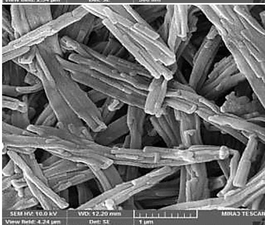
شکل ۳ تصویرهای SEM ساختار هسته-پوسته پلی‌پیرول/پلی‌آنیلین تهیه شده
