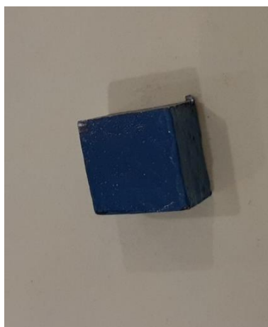
شکل ۱: نمونه فولاد X65 برای آزمون‌های امپدانس و پلاریزاسیون
