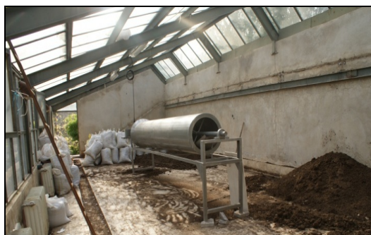
شکل ۲- دستگاه سرند دوار برای جداسازی کرم و
