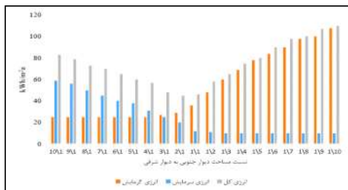
شکل ۶- تغییر میزان مصرف انرژی بر اساس نسبت های مختلف از مساحت دیوار جنوبی به دیوار شرقی
