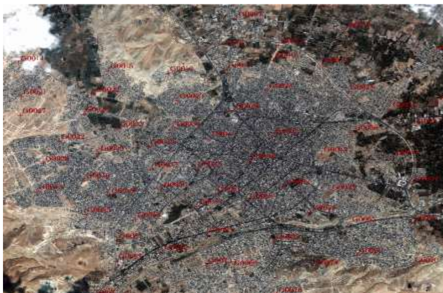
شکل ۱: قسمتی از تصویر IKONOS (منطقه شهری ارومیه) به همراه توزیع نقاط کنترل و چک
