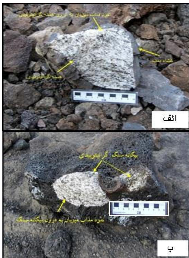
شکل ۳- نمایی از بمب و زنولیت های آتشفشان قرینه، الف- بمب با هسته گرانیتوئیدی، نفوذ مذاب میزبان (بخش های تیره) به درون هسته گرانیتوئیدی (بخش های تیره) به خوبی دیده می شود، ب- زنولیت گرانیتوئیدی، نفوذ مذاب میزبان (بخش های تیره) به درون زنولیت (بخش های تیره) به خوب دیده می شود.
