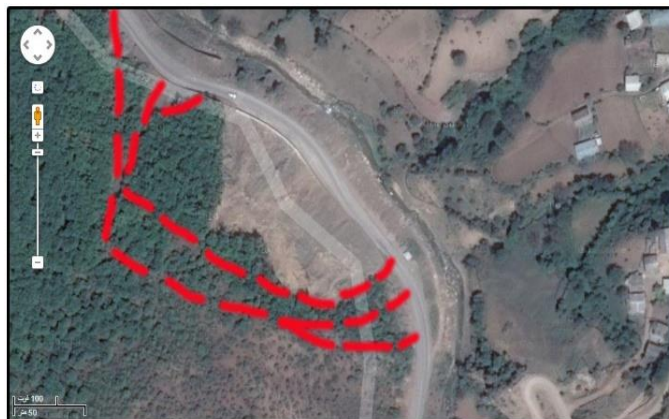
شکل ۶- عکس هوایی لغزش مورد مطالعه، بخش‌های با پتانسیل لغزش بالا با خط چین مشخص شده است.
