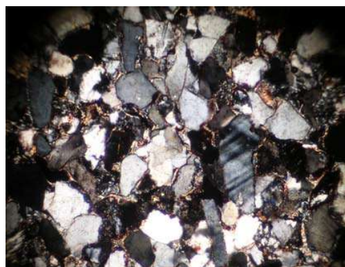
شکل ۱۴- مچوریتی بافتی از نوع نیمه بالغ مربوط به رخصاره فلدسپاتیک سد آرنایت. XPL
