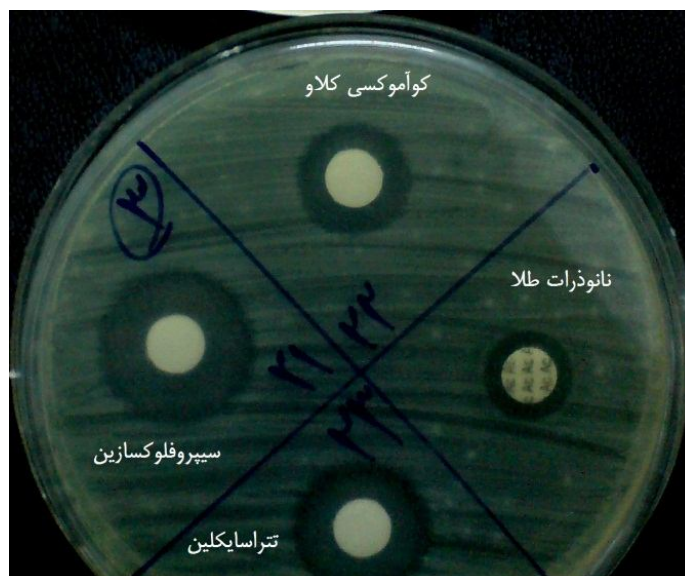
شکل ۱۱: هاله عدم رشد نانوذرات طلا و آنتی بیوتیک‌های مورد آزمایش علیه باکتری استافیلوکوکوس اورئوس
