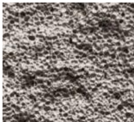
شکل ۵: ساختار متخلخل بتن هوادار (Ahmed & Kamau, 2017)
