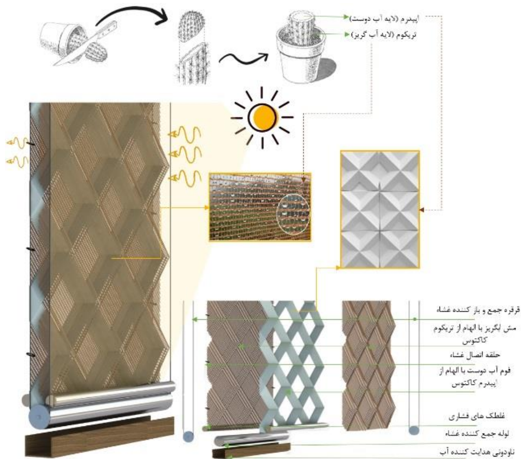
تصویر ۸. معرفی عناصر و نحوه عملکرد پوسته ساختمانی طراحی شده با مکانیزم جذب رطوبت کاکتوس و سایه‌اندازی آن بر نمای ساختمان (ماخذ: نویسندگان)
