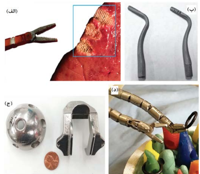
شکل ۴. نمونه هایی از ابزارهای جراحی چاپ سه بعدی فلزی. (الف) گیره الکتروسرجری با Ti-۶۴ چاپ شده با PBF، نوک گیره در کنار جگر خوک با چندین بخش منعقد شده (ب) بخش دهانی چاپ شده با PBF از یک بالابر دندانپزشکی (ج) راهنمای برشی از استخوان استابولوم لگن چاپ شده با PBF از SS316L (د) یک جفت بازوهای رباتیک جراحی چاپ شده از SS316L [۷۶].
