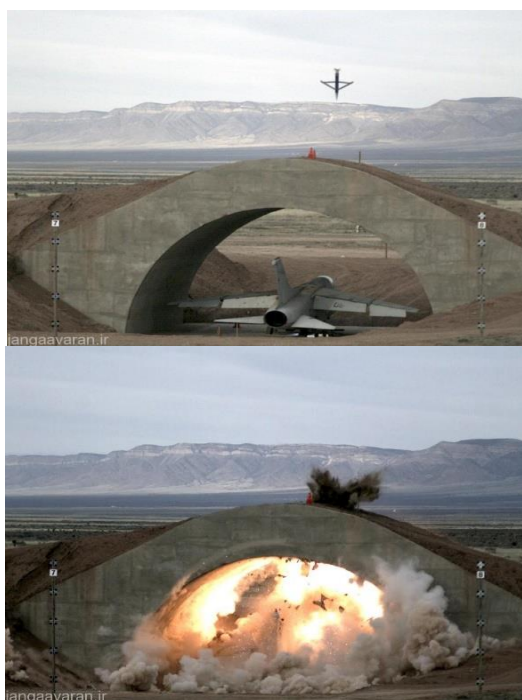
شکل ۱۶- نمایی اصلی از شیلتر محافظ بتنی
